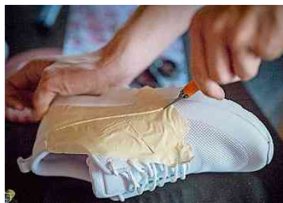
Mit Klebeband wird die Form des zu veredelnden Teils abgenommen.
